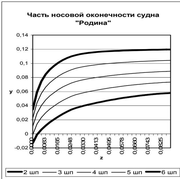
Рисунок 2П<sub>2</sub> Расчётные шпангоуты, полученные по двум кромочным
