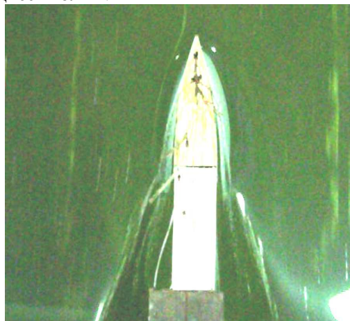
Рис. 9. Кадр из видеопленки, снятого во время движения длинной аналитической модели. Эксперименты проводят аспиранты Краснов А. В. и Краснов А. В.
