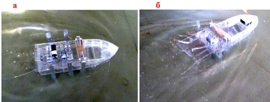
Рис. 7. Движение модели с расположением плавника под днищем (а) и смещённым в корму (б)
