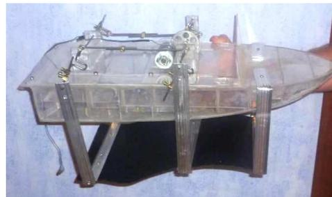
**Рис. 5.** Экспериментальная модель судна с плавниковым движителем
