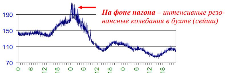
**Рис. 6.** Резонансные колебания в Холмской бухте на фоне штормового нагона. Запись неперiodических колебаний (вычтен прилив) за 22–24 ноября 2005 года
