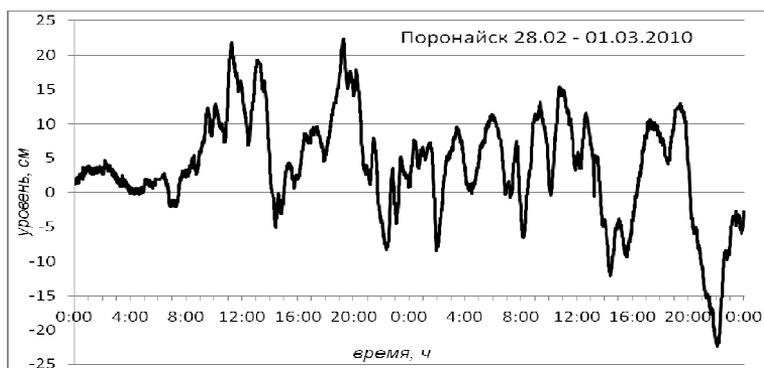
**Рис. 16.** Двухсуточный отрезок записи Чилийского цунами 28 февраля – 1 марта 2010 г (вычтен предвычисленный прилив) на датчике СПЦ в порту Поронайск
